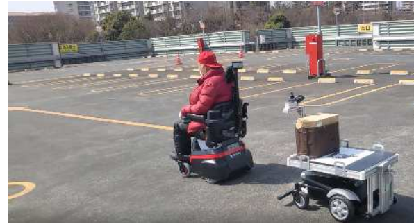
自動車いす・ガルーの自動運転の後を、自動運搬ロボット・サウザーが自動追従
