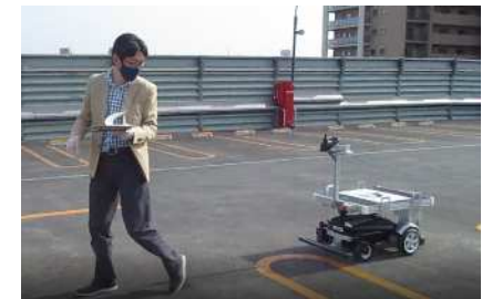
自動運搬ロボット・サウザー自動追従
